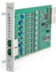
Организация абонентских линий связи и обеспечивает двухпроводное подключение восьми абонентских комплектов АТС.
