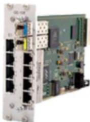
На плате установлено два оптических порта, по каждому из которых одновременно передаётся до 88 потоков E1 и данные Ethernet 1000 Мбит/с.
