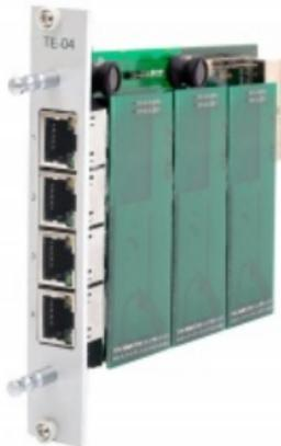
Организация нескольких каналов передачи трафика Ethernet по цифровым TDM потокам – режим: «точка-мультиточка» до 4-х направлений.
