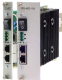
Питание плат блока MC04–DSL–3U содержат преобразователь DC/DC, который преобразует стационарное постоянное напряжение (36...72 В – для платы PS-48 и 21...72 В – для платы PS-24D) в постоянное напряжение 120,3 В.
