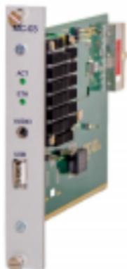
Оснащена ARM четырёх ядерным процессором Cortex-A53 и модулем оперативной памяти 2 Гб, накопитель eMMC 32 Гб.
