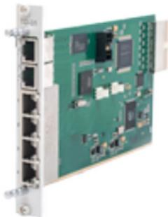
Передача 4-х потоков E1 (полных и дробных) через сеть Ethernet. Плата имеет 4 внешних порта E1, коммутатор Ethernet с четырьмя внешними портами Ethernet 10/100-BASE-T (Auto negotiation).
