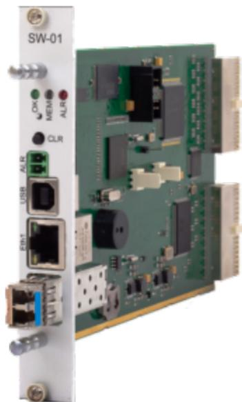
Плата SW-01 обеспечивает взаимодействие оператора с блоком, хранит конфигурацию блока, передаёт управляющую информацию к платам блока, отслеживает состояние плат блока.
