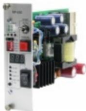
Дистанционное питание (ДП) регенераторов или выносной (удалённой) аппаратуры связи. Плата устанавливается в любое из мест 1 – 7, 11 – 18 базового блока MC04–DSL–3U рядом с платой **SM**, в тракт которой вводится ДП.
