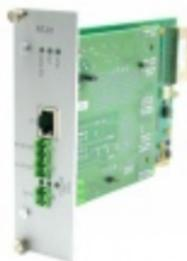
Для подключения к блоку MC04–DSL–3U ретранслятора MC04-RT. Ретранслятор MC04-RT входит в состав системы диспетчерской связи, разработанной ООО «АДС» для организации дуплексной беспойсковой радиотелефонной связи ведомственных и корпоративных сетей на одном из 16 радиочастотных каналов между подвижными объектами и абонентами радиокабельных сетей связи в диапазоне частот от 136 до 174 МГц.
