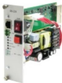
Электропитание блока MC04–DSL–3U в буфере с одной внешней аккумуляторной батареей (АКБ) с номинальным напряжением 12В (возможно также использование платы при отсутствии АКБ).
