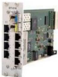
Передача данных Ethernet и потоков E1 по волоконно-оптическому кабелю с использованием технологии SDH STM-1.
