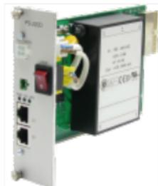
Платы типа PS-220, PS-220D, PS-220-BRS, PS-650DT предназначены для питания плат блока MC04-DSL-3U и содержат преобразователь AC/DC, который преобразует напряжение дистанционного питания (ДП) или сетевое напряжение 220В/50Гц в постоянное напряжение 120,3 В / 40 Вт.
