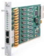
Организация абонентских линий связи и обеспечивает двухпроводное подключение восьми телефонных аппаратов.
