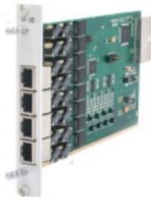
Приём/передача до 8 сигналов ТЧ в диапазоне частот от 300 до 3400 Гц.
