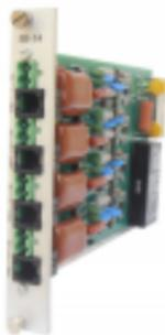
Подключение телефонных аппаратов с индукторным вызовом типа ТА–57, ТА–88 в режиме питания от местной батареи (МБ).
