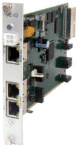
Полнофункциональный голосовой VoIP-шлюз, который позволяет объединить телекоммуникационные сети с коммутацией каналов (TDM) и сети с коммутацией пакетов (IP) для передачи данных и голоса.
